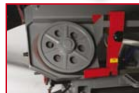
Präzisionsgußrad precise cast iron wheel
