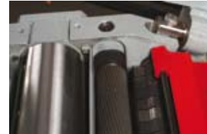
spiralverzahnte Einzugschwelle spiral-toothed infeed roller
