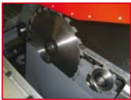
VORRITZER MIT EIGENEM ANTRIEB SCORING UNIT WITH SEPARATE DRIVE
