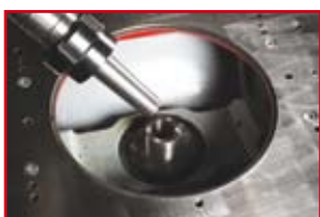
austauschbarer Fräsdorn MK4 exchangeable spindle MT4
