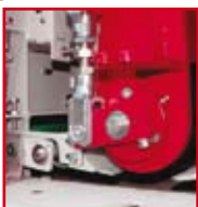
Drückleisten zum Schleifen sehr kurzer Werkstücke pressing boards to grind very short work pieces
