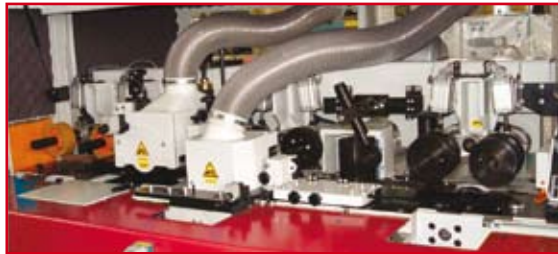
robuster, massiver und schwingungsarmer Aufbau in Stahl-Graugusskonstruktion
