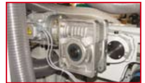
extrem belastbares Materialeinzugsystem. Antriebsmotor ausgerüstet mit eigenem Kühlsystem und stufenlos regulierbar von 5-20 m/min
